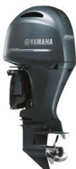
**Motor DOHC de 2,8 litros y cuatro cilindros, 16 válvulas, VCT y EFI**
